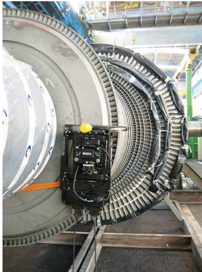
Рис. 3. Пример крепления прибора на роторе турбины
