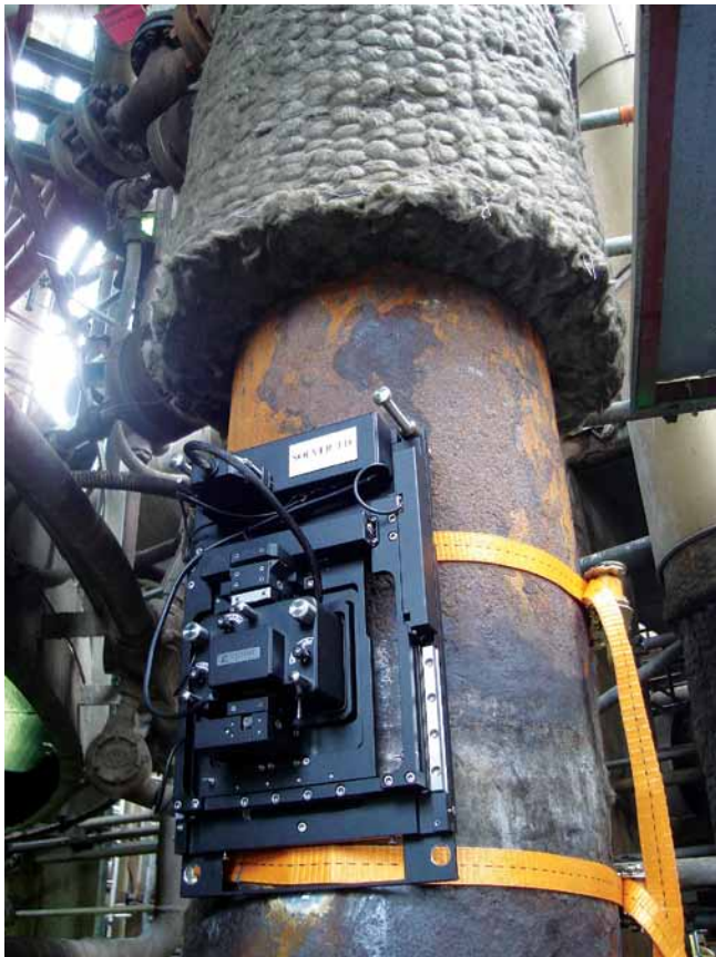
Рис. 2. Пример крепления прибора на трубе
