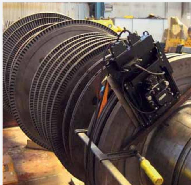
Пример крепления прибора на роторе турбины
