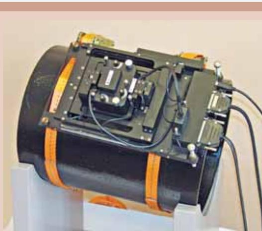
Прототип атомно-силового микроскопа СОЛВЕР Пайп
