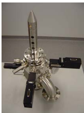
Колонна РЭМ с электростатической фокусировкой и катодом Шоттки
