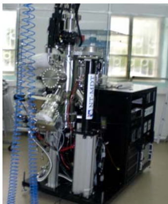
Модуль лазерной абляции (KrF эксимерный лазер, 248 nm, 20 nsec, 400 mJ, 20 Hz)
